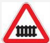
1.1 «Железнодорожный переезд со шлагбаумом»
