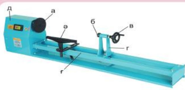
Яғачни йонийдиған станок қурулуши
