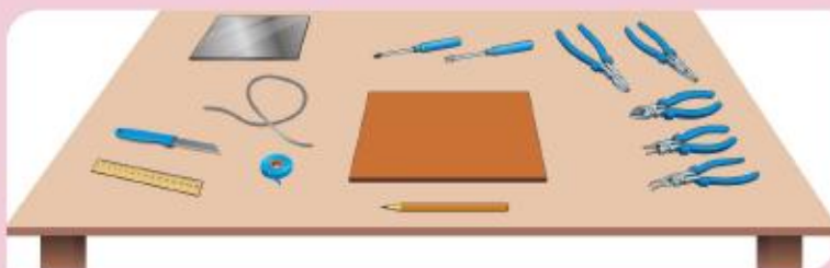
Электр монтажлаш иш орнини қуралландуруш
