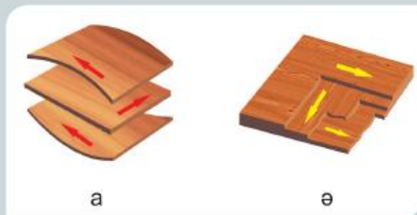
Үч қәвәтлик фанериниң схемиси: а – шпон тахталириниң орунлишиши; ә – тахтиларни преслаш
